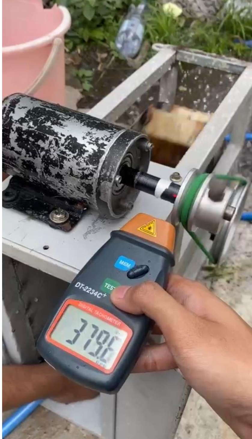
Gambar 5. 2 Pengukuran rpm pada generator
