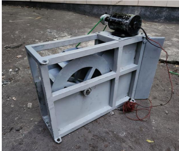
Gambar 4. 10 Tampak samping hasil perancangan Sistem PLTPH
