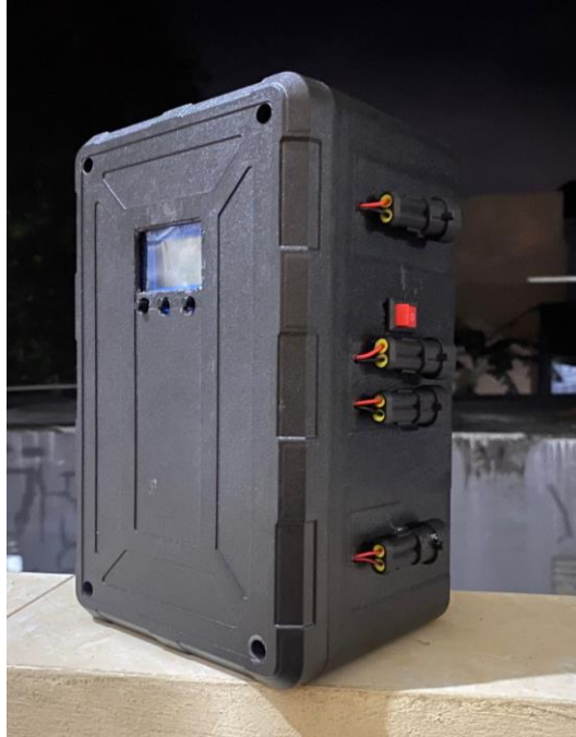
Gambar 4. 4 Tampak luar panel kontrol elektronis
