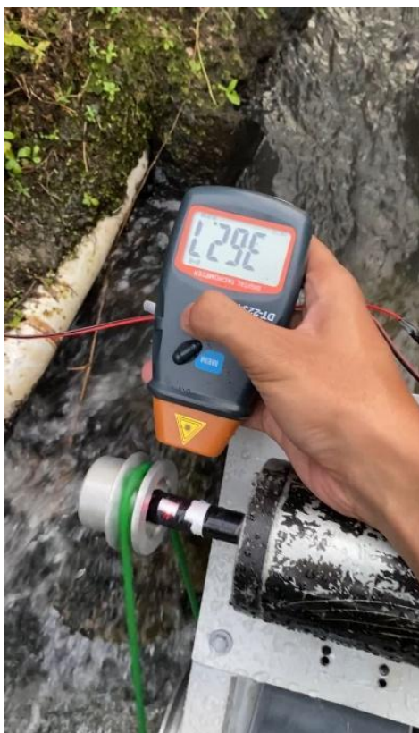
Gambar 5. 6 Pengambilan data kecepatan putaran generator di Lapangan
