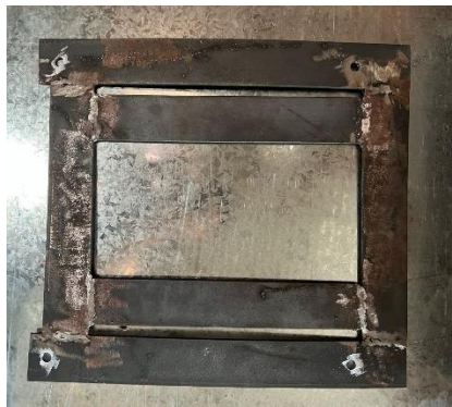
Gambar 4-15 Hasil Pengelasan Untuk Komponen Bawah Jok
