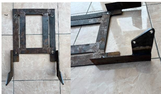
Gambar 4-16 Hasil Penyambungan Komponen Segitiga dan Bawah Jok
