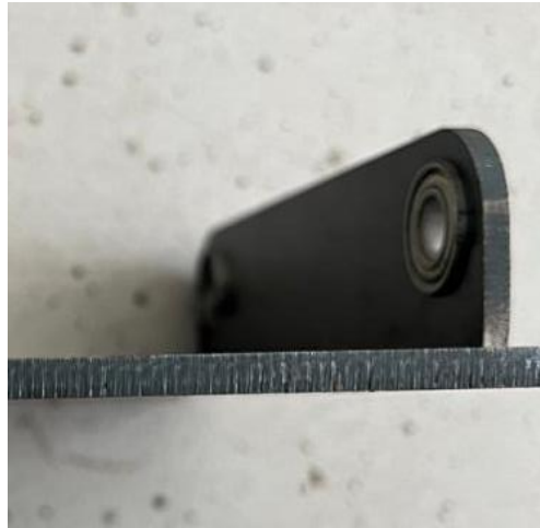
Gambar 4- 2 Kesalahan Bending pada Base Conveyor
