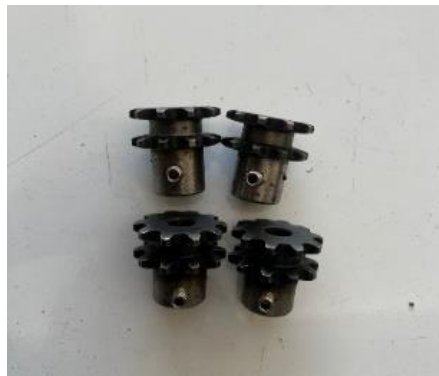
Gambar 4- 5 Sprocket Gear yang Sudah Dilubangi
