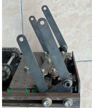
Gambar 4-13 Hasil Pemasangan Komponen Lengan pada Base Utama
