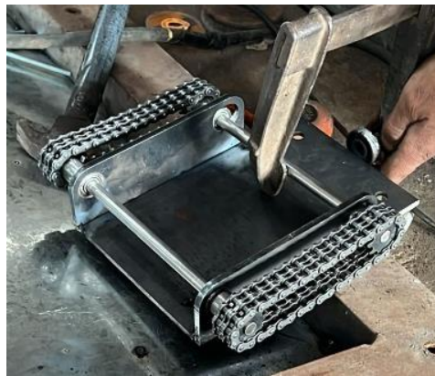
Gambar 4-7 Pemasangan Rantai pada Base Conveyor
