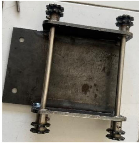
Gambar 4- 6 Base yang Terpasang Besi AS dan Sprocket Gear
