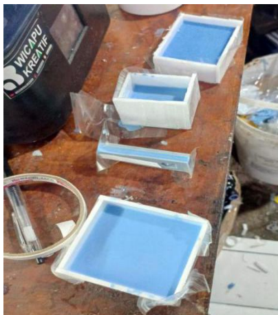
Gambar 4-16 Proses Pembuatan Cetakan
