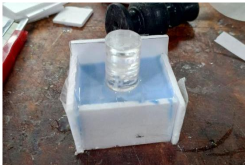
Gambar 4-15 Penambahan material untuk mengurangi silikon yang digunakan
