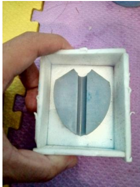
Gambar 4-14 Penempelan master pada wadah
