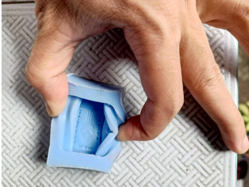
Gambar 44 Cacat yang disebabkan oleh gelembung
