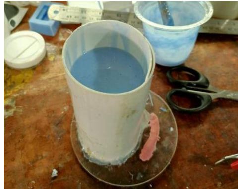
Gambar 4-17 Pembuatan cetakan pion
