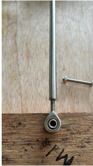
Gambar 4- 5 Hasil Pemasangan rod end bearing dan shaft
