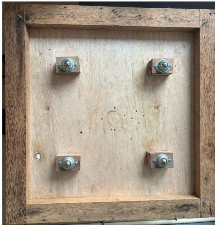
Gambar 4- 11 Hasil Pemasangan Ball Transfer Unit
