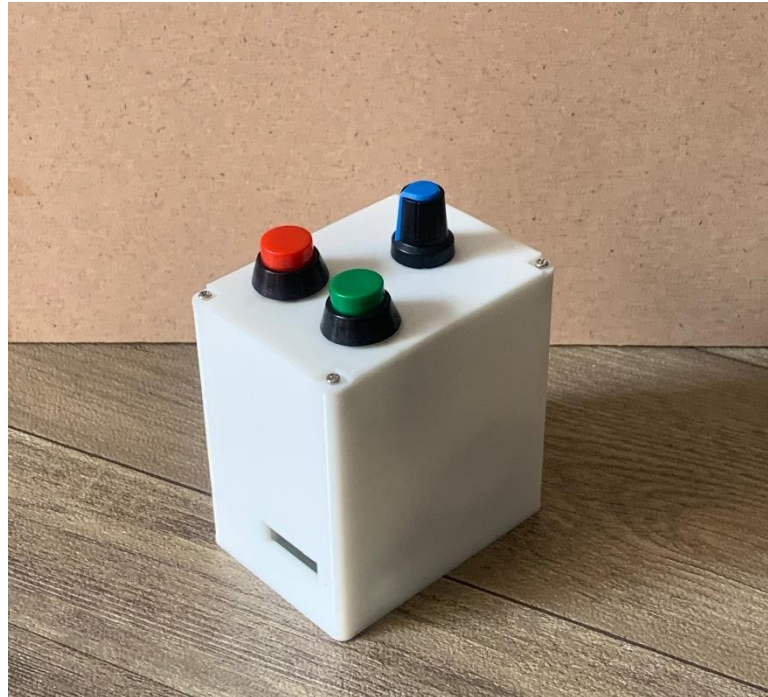
Gambar 4- 6 Assembly Pelindung PWM Module Relay dan Pushbutton
