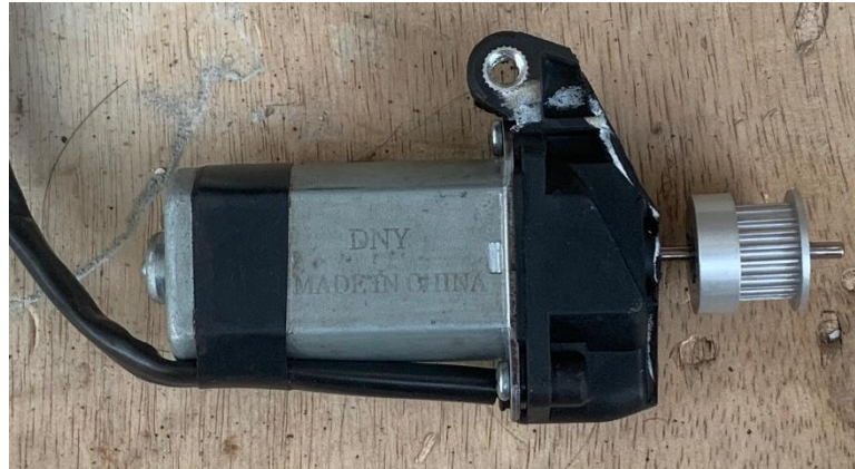
Gambar 4- 16 Modifikasi Power Window
