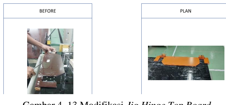
Gambar 4. 13 Modifikasi Jig Hinge Top Board
