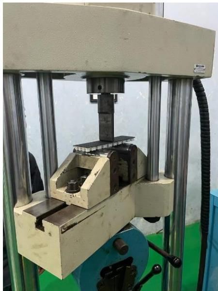
Gambar 4- 2 Pengujian *Bending*
