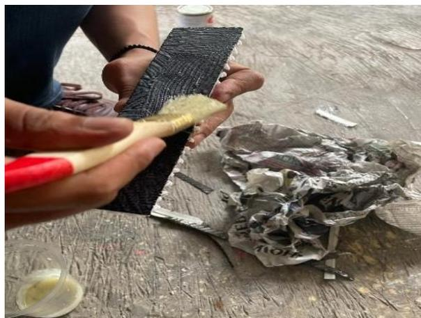
Gambar 3- 26 Proses Penyatuan *Skin* dan Spesimen dengan Metode *Hand Lay Up*
