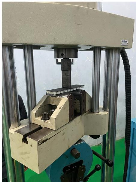
Gambar 2- 7 Pengujian *bending*
