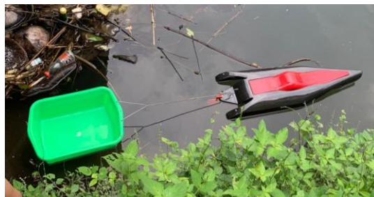
Gambar 4- 22 Rangkaian kapal dengan box
