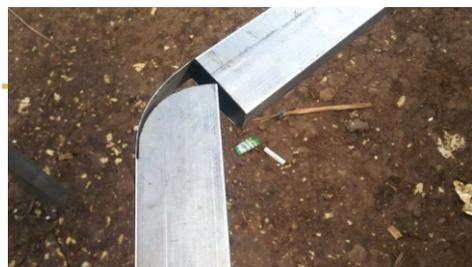
Gambar 5.25 Sambungan Bending
