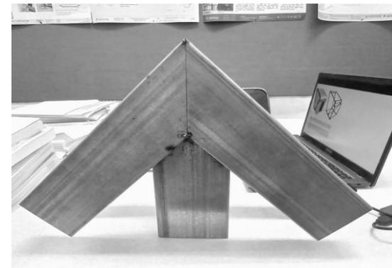
Gambar 3.6 Hasil sambungan alternatif sambungan
