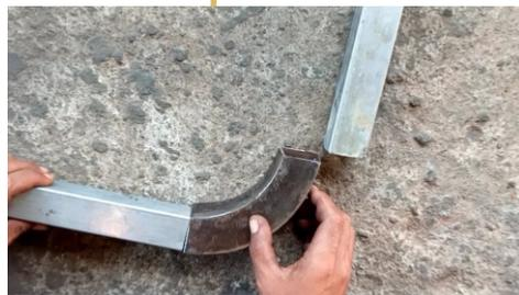
Gambar 5.24 Sambungan Bending
