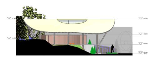
Pada bangunan lobby terdapat pondasi penahan sehingga tanah tidak bergeser karena bangunan terletak memotong kontur.
