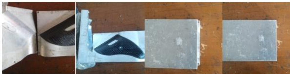
Gambar 4-10 Pencetakan produk komposit prepreg carbon fiber
