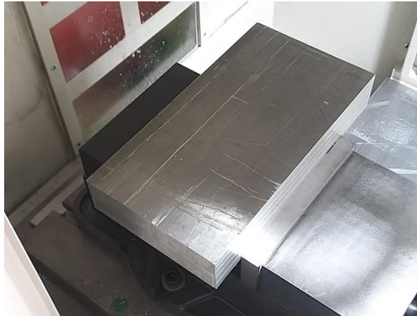
Gambar 3-20 Mencekam benda kerja aluminium pada ragum mesin CNC milling
