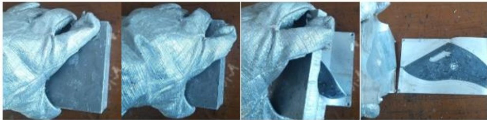
Gambar 4-9 Pencetakan produk komposit chopped carbon fiber
