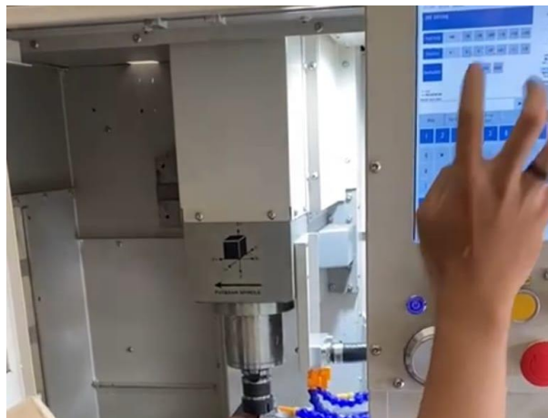
Gambar 3-21 Menyalakan mesin dan melakukan kalibrasi
