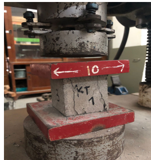
Gambar 4.19 Pengujian Kuat Tekan
