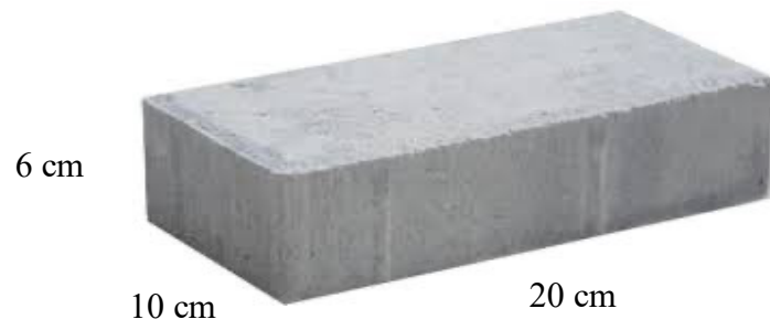
Gambar 3. 3 Sketsa Benda Uji Terhadap Penyerapan Air
