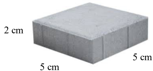
Gambar 3. 2 Sketsa Benda Uji terhadap Ketahanan Aus
