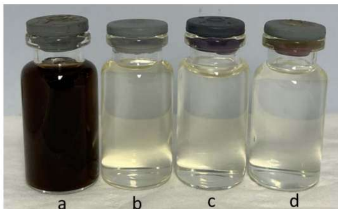
Gambar 15. Hasil pengolahan air gambut menggunakan ekstrak koagulan dengan NaCl 1 M. Air gambut awal (a), pengadukan lambat 20 menit (b), pengadukan lambat 25 menit (c), dan pengadukan lambat 30 menit (d).
