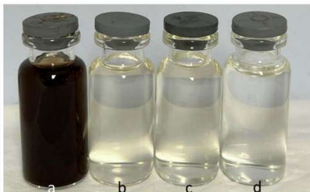
Gambar 16. Hasil pengolahan air gambut menggunakan ekstrak koagulan dengan aquades. Air gambut awal (a), pengadukan lambat 20 menit (b), pengadukan lambat 25 menit (b), dan pengadukan lambat 30 menit (c)
