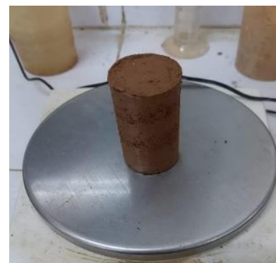
Gambar 5.10 Sampel Tanah Asli untuk Pengujian Triaksial UU
