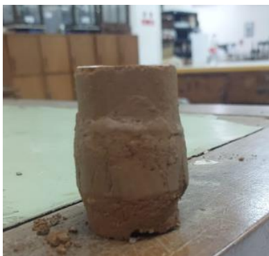
Gambar 5.10 Sampel Tanah Asli untuk Pengujian Triaksial UU
