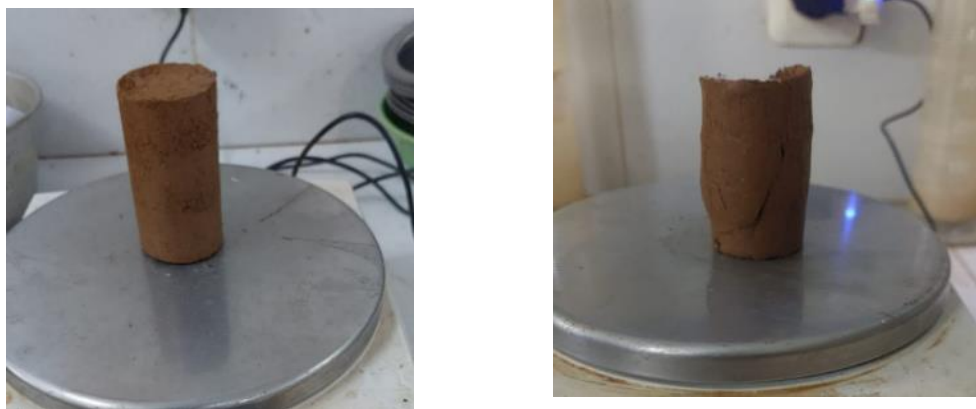
Gambar 5.24 Sampel Tanah Asli + Semen 1% + Rotec 1% untuk Pengujian Triaksial UU
