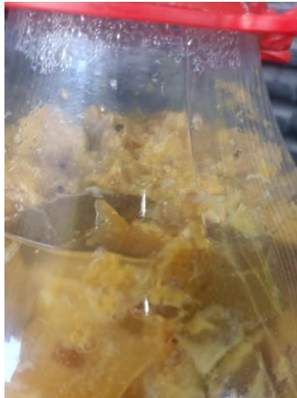
Gambar 4. 4 Gas yang Terbentuk Selama Fermentasi
