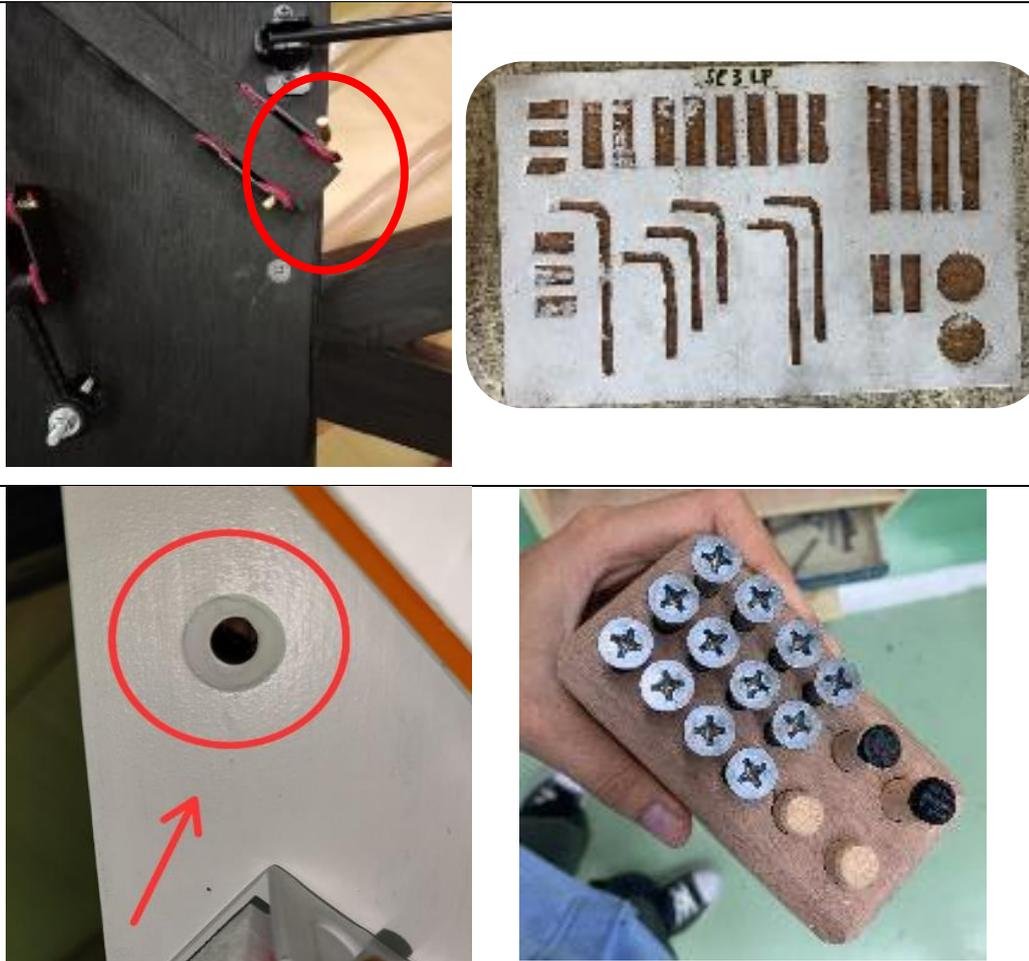
Beberapa kaizen yang dilakukan guna mengurangi *defect* produk atau potensi NG nyata dengan melakukan pembuatan *tray* untuk penempatan *screw* sesuai dengan jumlah *screw* yang terpakai.
