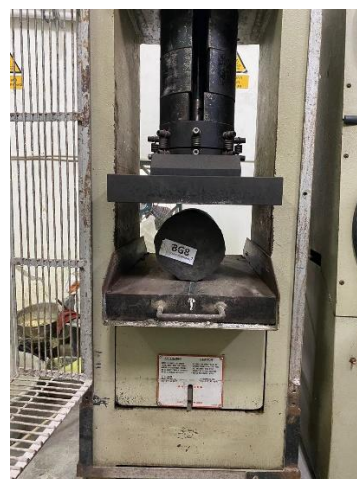
Gambar 5.23 Contoh Pengujian Kuat Tarik Belah Beton
