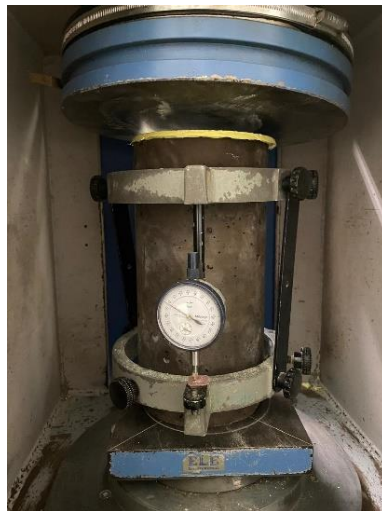
Gambar 5.20 Contoh Pengujian Modulus Elastisitas Beton
