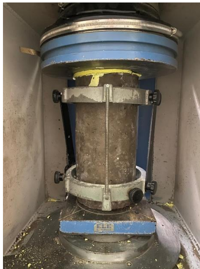
Gambar 5.18 Contoh Pengujian Kuat Tekan Beton
