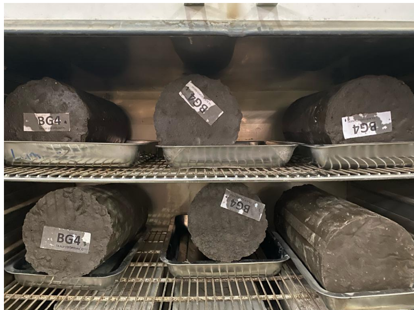
Gambar L-5.8 Perawatan Benda Uji dalam Oven
