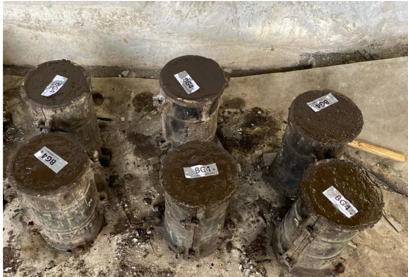
Gambar L-5.7 Beton Geopolimer dalam Bekisting
