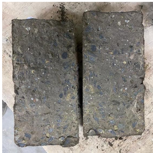
Gambar 5.24 Contoh Hasil Uji Tarik Belah Beton Geopolimer
