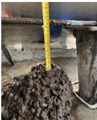
Gambar 5.9 Contoh Uji Slump
