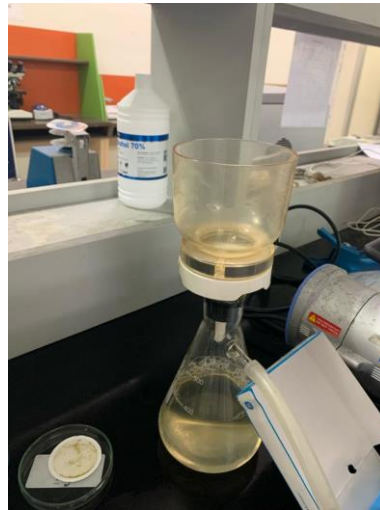
Gambar 3. 8 Proses Penyaringan Sampel
