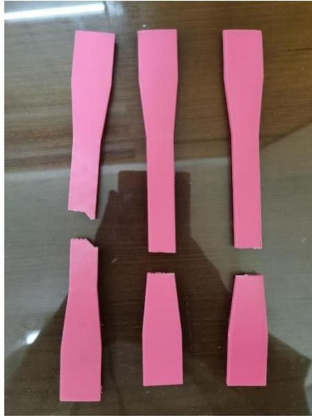
Gambar 4- 13 Hasil spesimen uji PLA+ tipe 1
