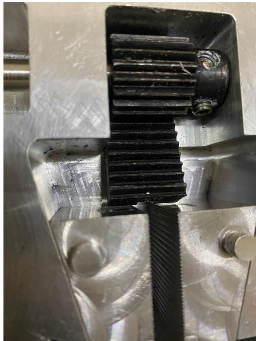
**Gambar 4- 18 Mekanisme Pendorong Clamp**
