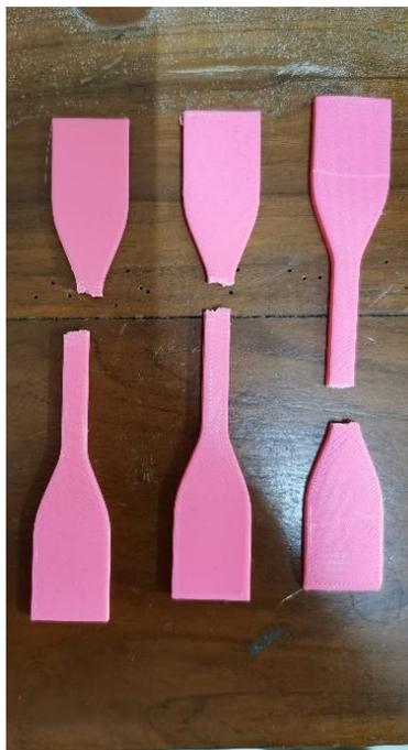
**Gambar 4- 11 Hasil spesimen uji PLA+ tipe 4**
