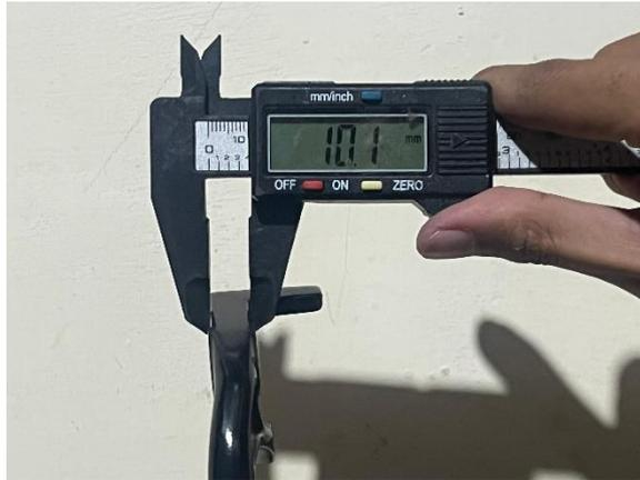
Gambar 4-37 Pengukuran Ketebalan *Lever Brake* Asli
