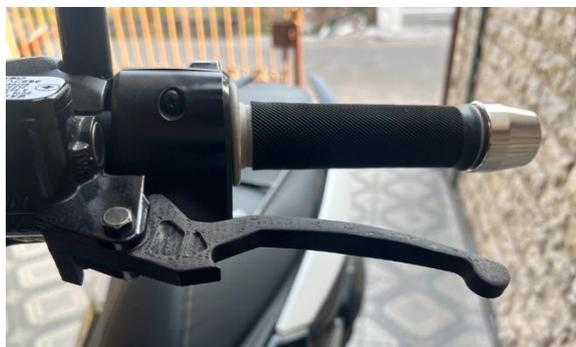
Gambar 4-14 Hasil Pemasangan Prototipe *Lever Brake*
