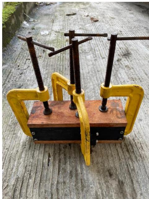
Gambar 4-25 Penekanan *Molding* Menggunakan *Clamp C*
