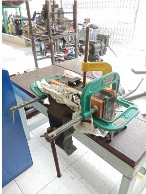
Gambar 4-28 Penekanan *Molding* Menggunakan Ragum dan *Clamp C*
