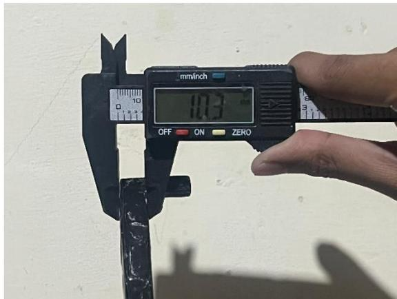
Gambar 4-38 Pengukuran Ketebalan *Lever Brake Custom*
