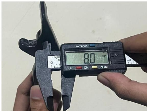
Gambar 4-36 Pengukuran Diameter Lubang Baut *Lever Brake Custom*
