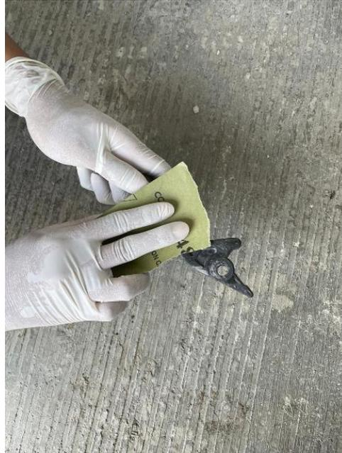
Gambar 4-32 Pengamplasan Produk menggunakan Amplas Persegi
