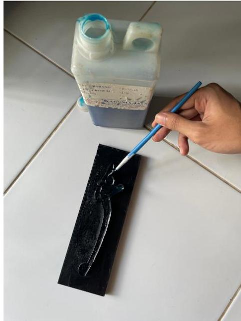
Gambar 4-23 Pelapisan *Polyvinyl Alcohol (PVA)* pada *Molding*
