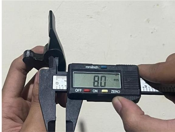
Gambar 4-35 Pengukuran Diameter Lubang Baut *Lever Brake* Asli
