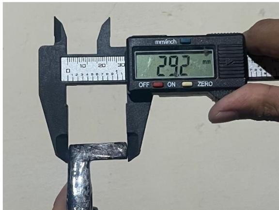
Gambar 4-40 Pengukuran Panjang *Trigger Switch* Rem *Custom*
