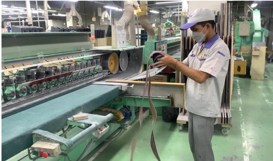
Gambar 4. 1 Proses Penggulungan *Belt Abrasive* Secara Manual.
