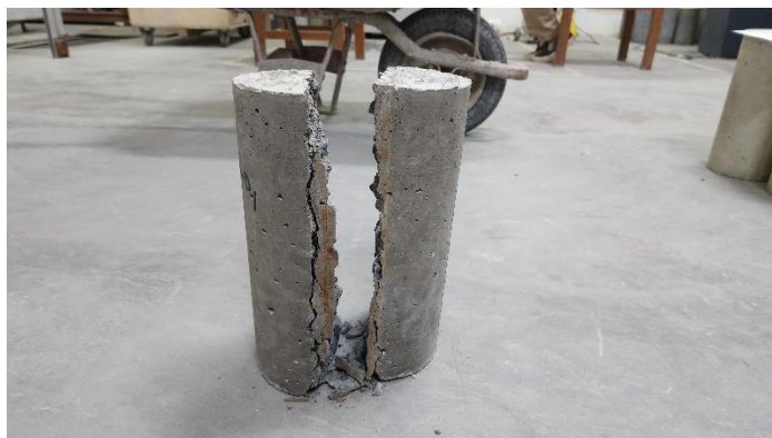
Gambar L-3. 4 Hasil Pengujian tarik Belah Beton
