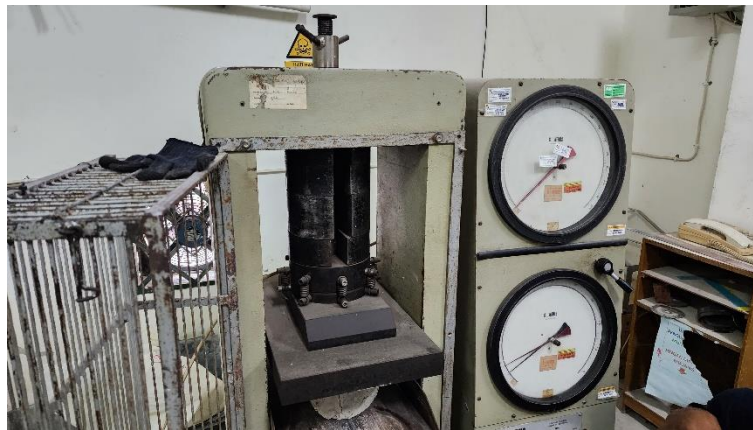
Gambar L-2. 8 Mesin Uji Tarik Belah Beton
