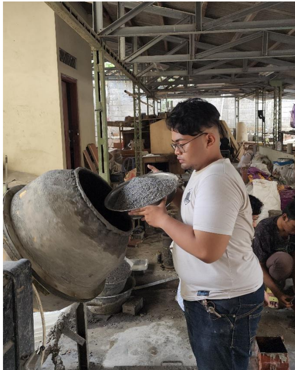
Gambar L-2. 19 Proses Pembuatan Benda Uji
