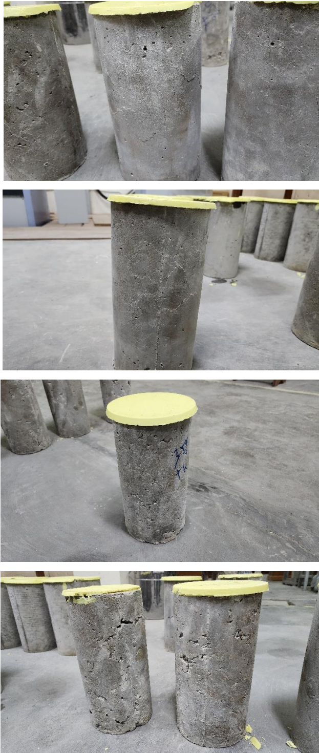
Gambar L-3. 2 Hasil Pengujian Kuat Tekan dan Modulus Elastisitas Beton
