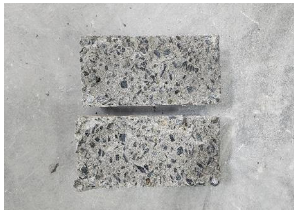
Gambar 5. 18 Hasil Pengujian Kuat Tarik Beton dengan Limbah Kertas
