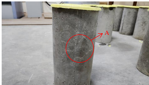
Gambar 5. 16 Hasil Pengujian Kuat Tekan Beton 0%
