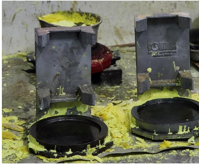
Gambar L-2. 7 Cetakan Capping Beton
