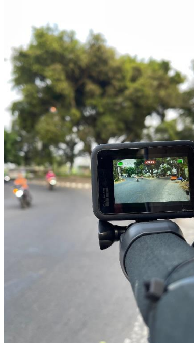
Gambar L-15.1 Pemasangan CCTV untuk Survei Volume Lalu Lintas
