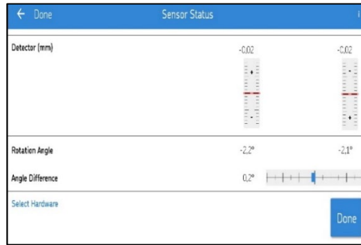
Gambar 3-9 Penyesuaian Tinggi dan Kelurusan Kedua Sensor
