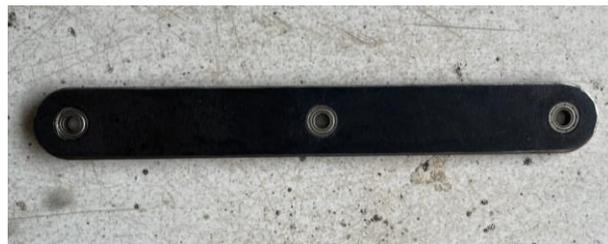
Gambar 4- 6 Hasil dari pembuatan lengan *scissors*
