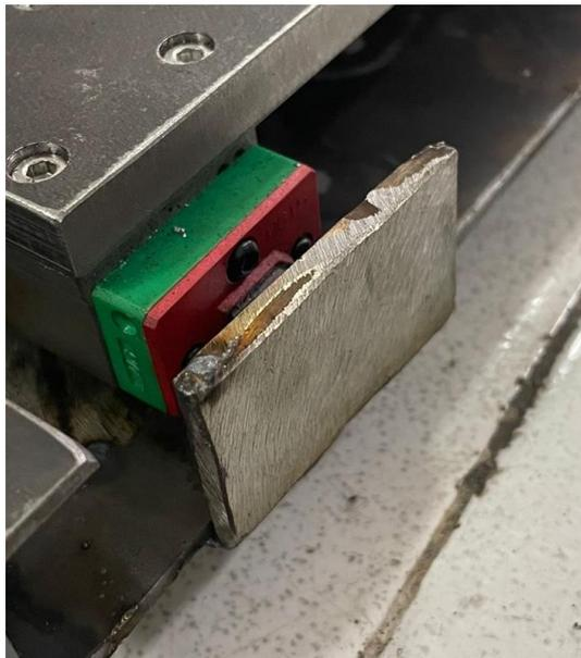
Gambar 4- 16 Komponen Pembatas *linear guide*
