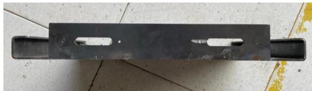
Gambar 4- 3 Hasil proses penyambungan belakang *base linear guide* HGR12 ke *base* bawah
