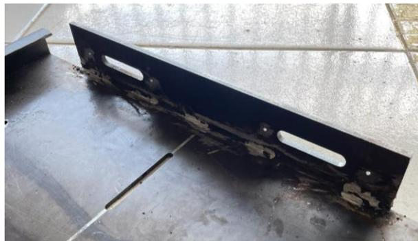
Gambar 4- 4 Hasil proses penyambungan depan *base linear guide* HGR12 ke *base* bawah
