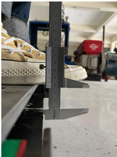
Gambar 4- 18 Pengukuran setelah diberi pembebanan manusia seberat 100Kg
