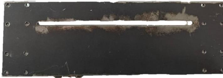
Gambar 4- 8 Base atas Penyambung *linear guide* ke base kursi
