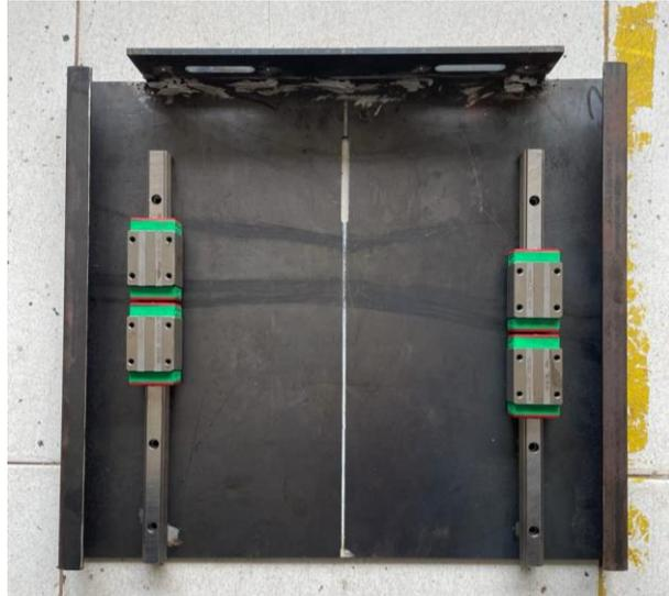
Gambar 4- 5 Hasil dari pemasangan *linear guide*
