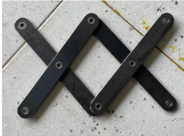
Gambar 4- 7 Hasil penyambungan lengan *scissors*.
