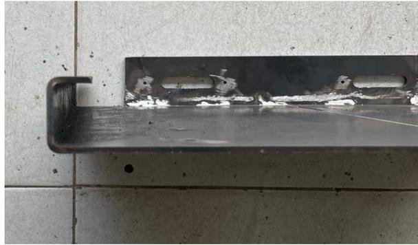
Gambar 4- 2 Hasil dari proses bending
