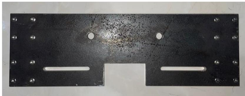
Gambar 4- 15 Hasil dari pemesinan CNC pada komponen *base* atas
