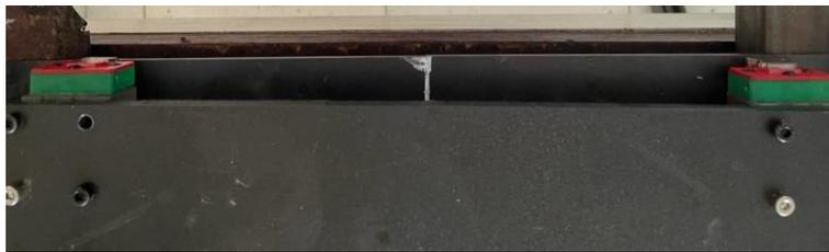
Gambar 4- 10 Hasil pemasangan *base* atas dengan *block linear guide*
