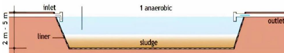
Gambar 2. 3 Skema Unit Kolam Anaerobik
