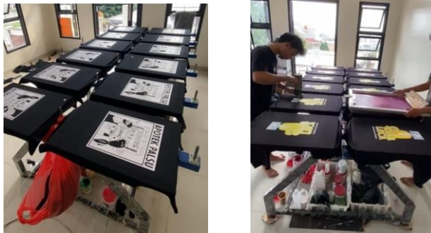
Gambar 3.3 Proses Sablon Kaos
