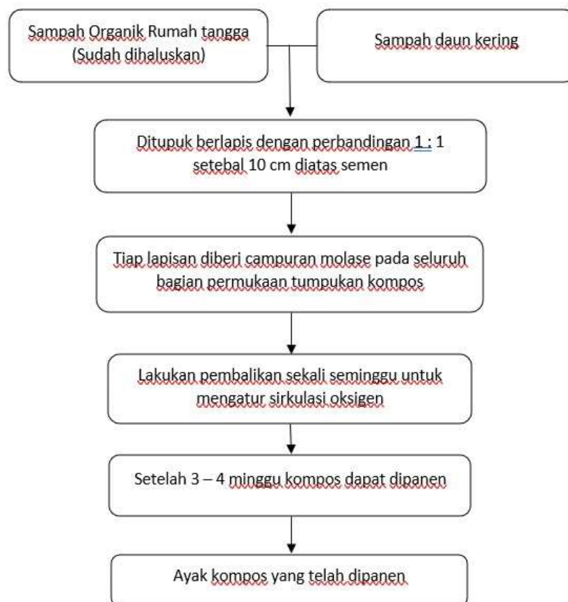
Gambar 3. 16 Diagram Alir Proses Pembuatan Kompos Metode Open Windrow
