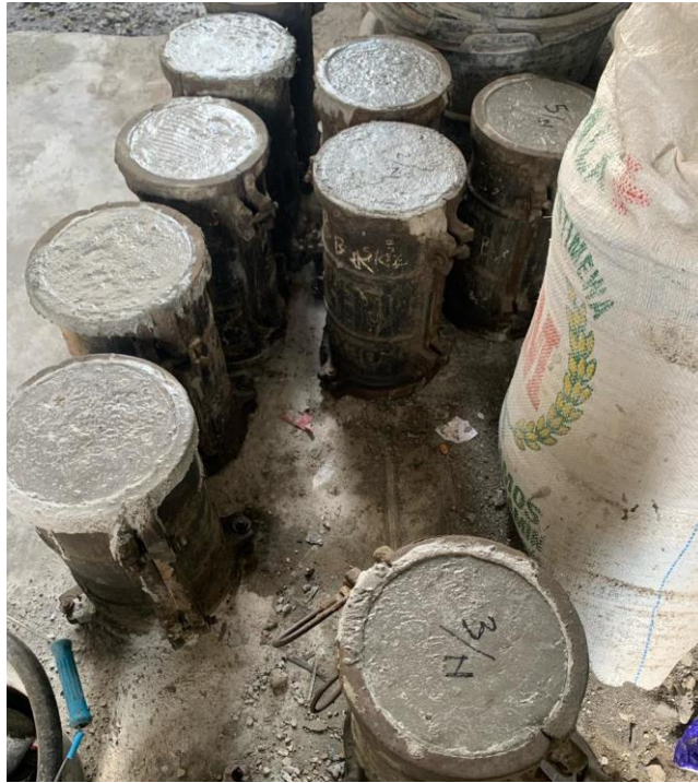
Gambar L-2. 19 Proses Pengerasan Campuran Beton
