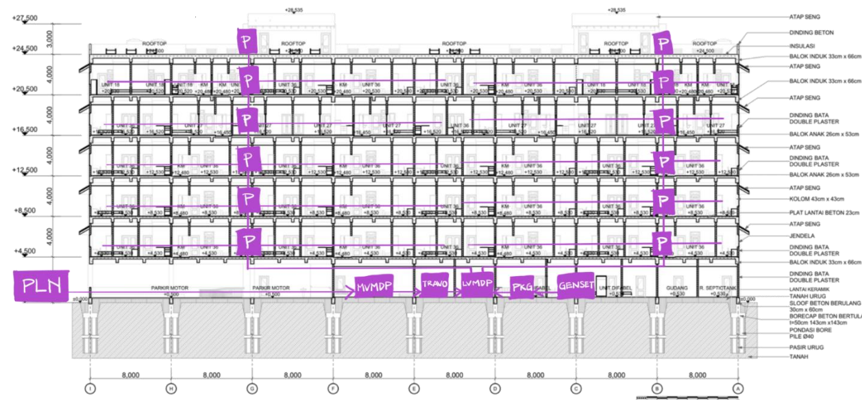
Gambar 155. Skema Utilitas Jaringan Listrik Bangunan
