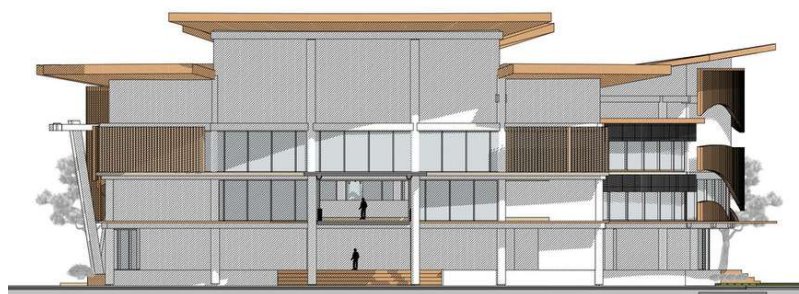
Gambar : Fasad Timur sebagai dsar uji OTTV Sumber : Analisis Penulis (2022)
