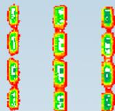
Hasil dari pengujian menggunakan velux terlihat hunian 2 pada bagian tengah di setiap lantai yang merupakan area kamar berwarna hijau hingga kuning yang menunjukkan intensitas cahaya 125-313 lux, sehingga desain berhasil memenuhi kriteria. Untuk bagian berwarna oranye dan merah merupakan bagian tepi dekat jendela dan juga koridor penghubung untuk sirkulasi pengguna bangunan.
