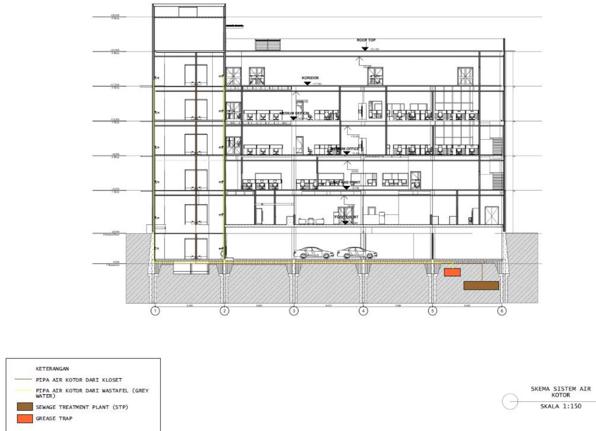
Gambar 5.9. Skema Sistem Air Kotor
