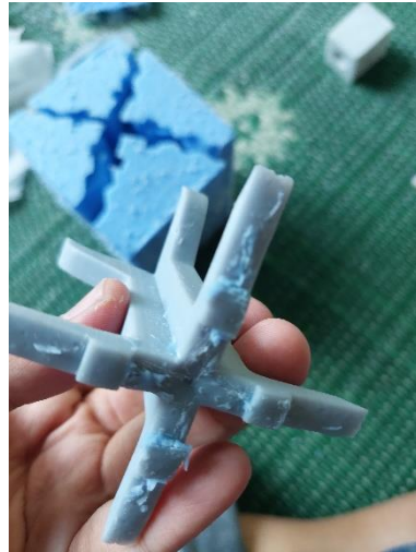
Gambar 4 - 27 Silikon Lengket pada Master Cetakan
