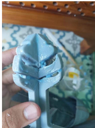
Gambar 4 - 21 Pelapisan Master Cetakan
