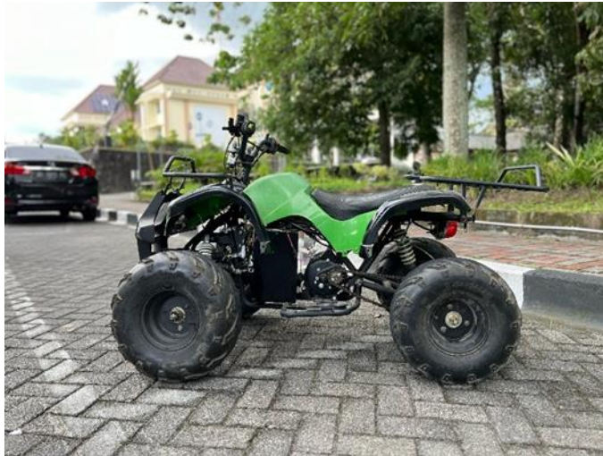
Gambar 4. 26 Hasil Mini ATV Setelah Proses Konversi Menjadi Berpenggerak Listrik
