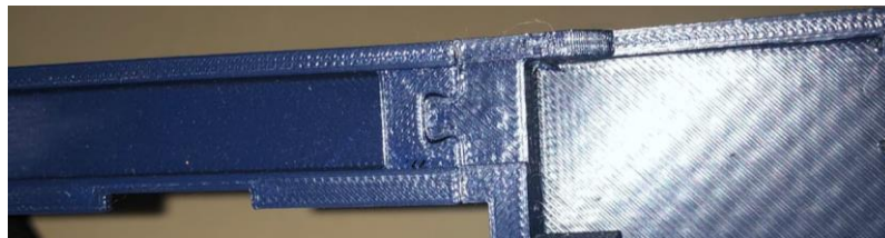
Gambar 4- 30 Skenario kegagalan locking sebelum ditekuk
