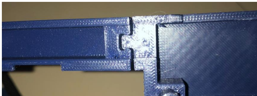
Gambar 4- 31 Skenario kegagalan locking sesudah ditekuk
