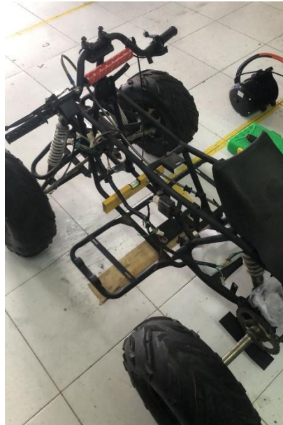
Gambar 4.1 Rangka Mini ATV Loncin 125 cc
