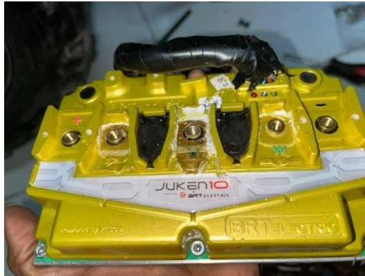
Gambar 4.27 Controller Meleleh pada Konektor 3 Fasa
