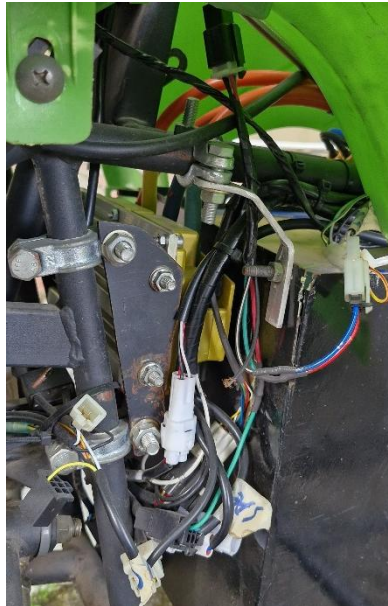
Gambar 4.10 Penempatan Soket-soket di Rangka Mini ATV
