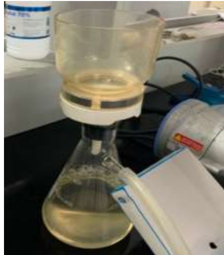
Gambar 3. 6 Proses Penyaringan Sampel Menggunakan Vacuum
