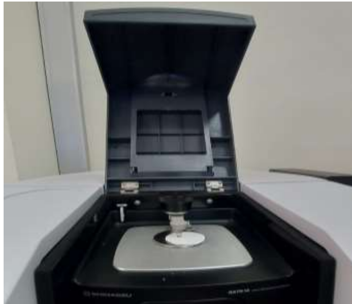
Gambar 3. 9 Tahapan Analisis Kandungan Polimer dengan Spektrofotometer FT-IR
