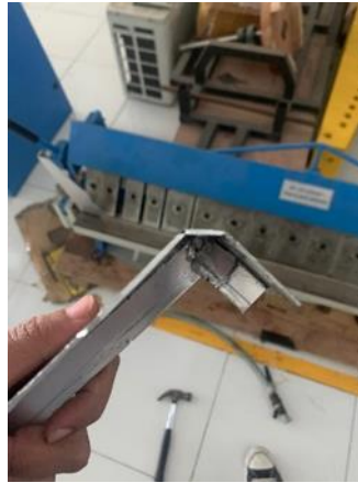
Gambar 4. 8 Hasil tekukan frame alat bantu.
