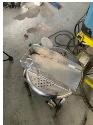
Gambar 4. 9 Hasil pengelasan alumunium.
