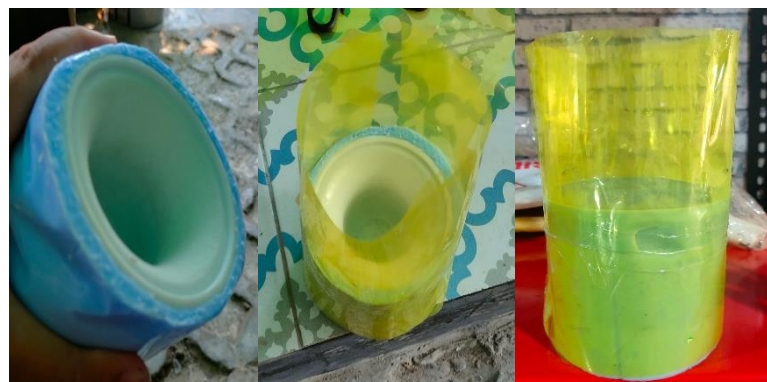
Gambar 4- 16 Proses pembuatan cetakan silikon bagian core atau inti
