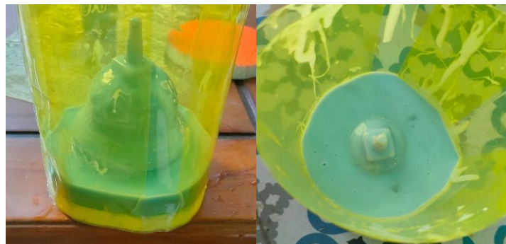
Gambar 4- 14 Proses pembuatan cetakan silikon dari wadah mika dan styrofoam
