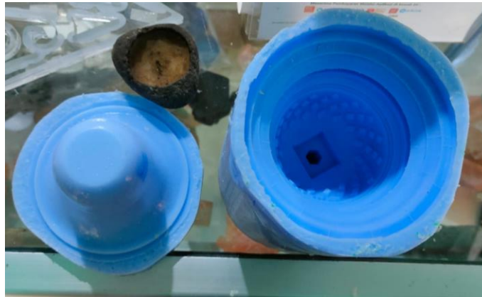
Gambar 4- 17 Hasil pembuatan cetakan silikon
