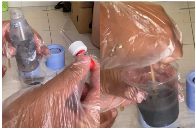
Gambar 4- 24 Pencampuran Katalis dan resin polyester
