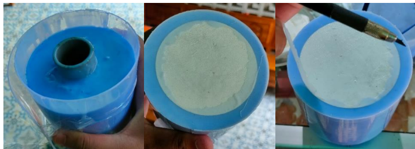
Gambar 4- 19 Pelepasan wadah cetakan dan master cetakan dari hasil pengeringan cetakan silikon
