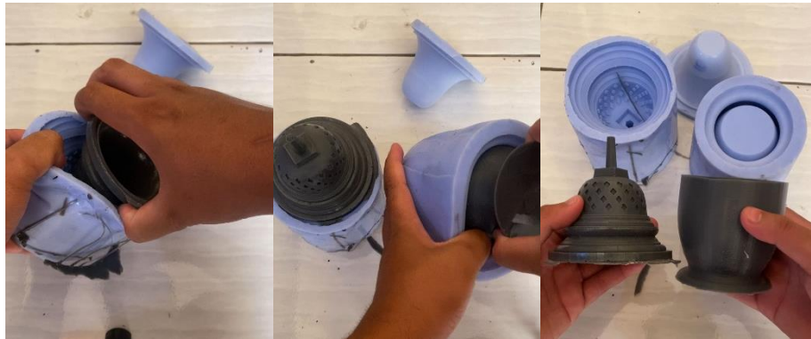
Gambar 4- 27 Pelepasan hasil cetakan souvenir
