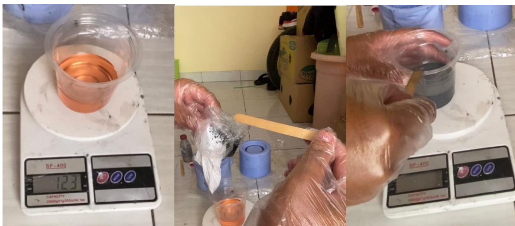
Gambar 4- 23 Menakar bahan resin serta campuran pigmen atau pewarna
