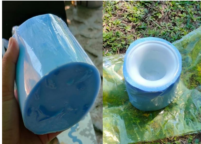
Gambar 4- 15 Hasil pembuatan cetakan silikon bagian cavity atau rongga
