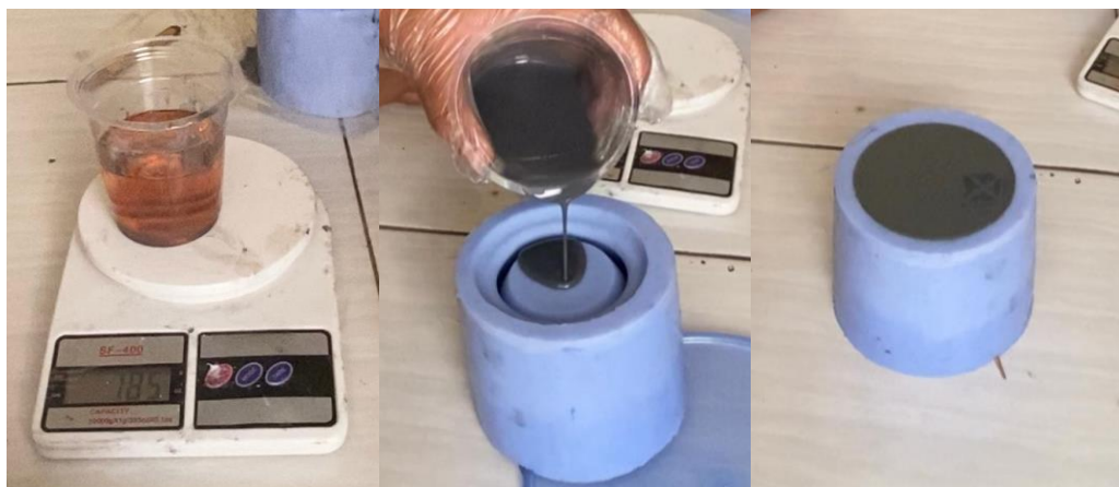
Gambar 4- 26 Penuangan campuran resin polyester kedalam cetakan silikon komponen mangkok
