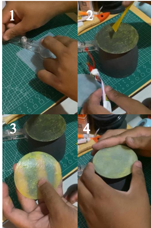
Gambar 4- 31 Pemasangan rubber sheet silicone
