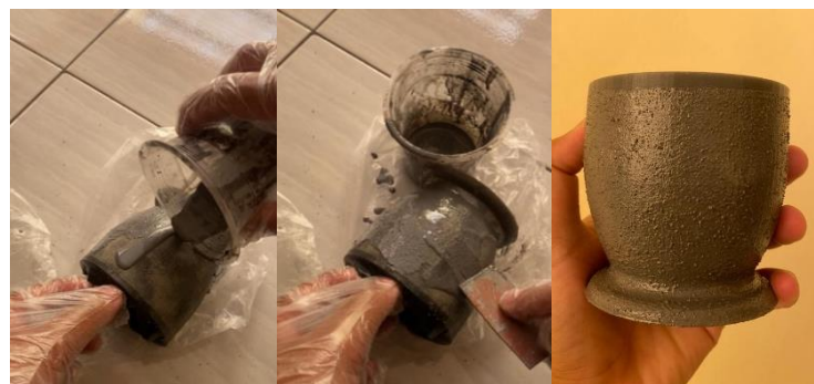
Gambar 4- 30 Proses finishing komponen mangkok sebagai tempat penyimpanan
