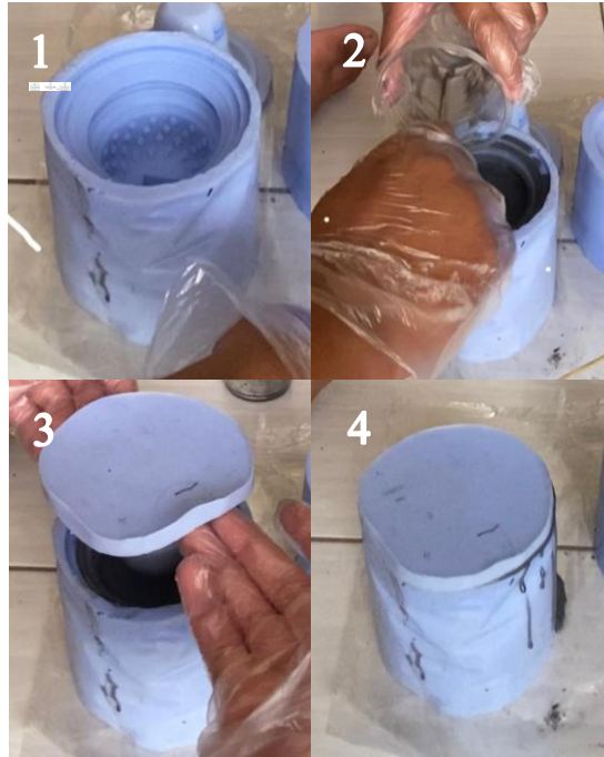
Gambar 4- 25 Penuangan campuran resin polyester kedalam cetakan silikon komponen Stupa Candi Borobudur
