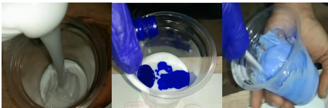
Gambar 4- 13 Pencampuran cairan silicone rubber RTV-52 dan katalis
