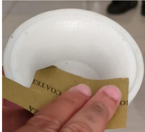
Gambar 4- 8 Proses amplas hasil cetakan
