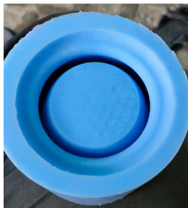
Gambar 4- 20 Hasil cetakan silikon untuk mangkok sebagai penyimpanan
