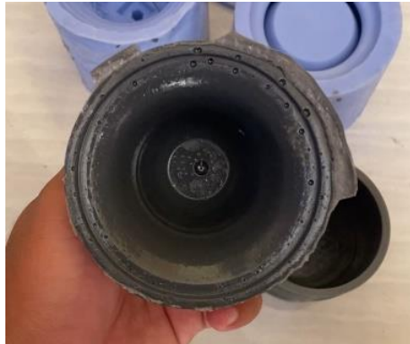
Gambar 4- 28 Udara terjebak pada cetakan yang menyebabkan terjadinya lubang-lubang
