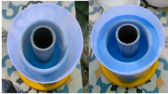
Gambar 4- 18 Penuangan cairan silicone rubber RTV-52
