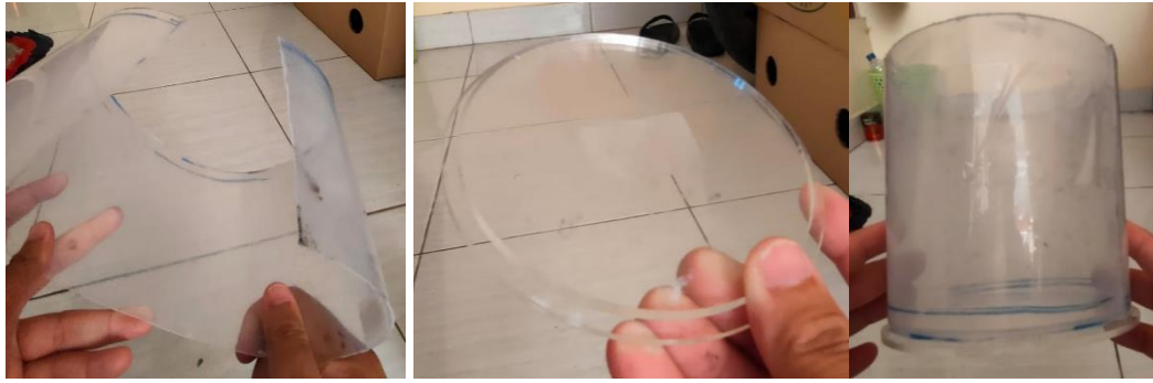
Gambar 4- 12 Proses wadah untuk pembuatan cetakan silikon
