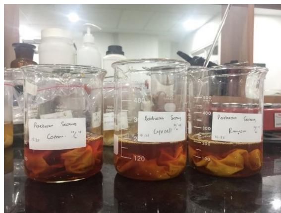
Gambar 3. 18 Proses Pewarnaan Ekstraksi Secang
