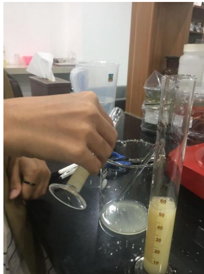
Gambar 3. 15 Proses Pembuatan Cairan Mordan dan Fiksator
