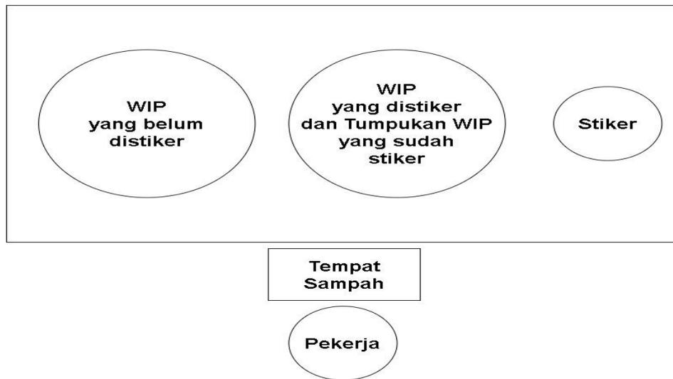
Gambar 5. 11. Tampak Atas *Layout* Usulan Tata Letak Penempelan Stiker *Doilies*
