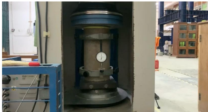
Gambar 5.10 Pengujian Modulus Elastisitas Beton Geopolimer
