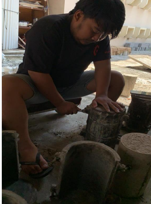
Gambar L-1. 13 Proses Pelepasan Beton Geopolimer dari Bekisting
