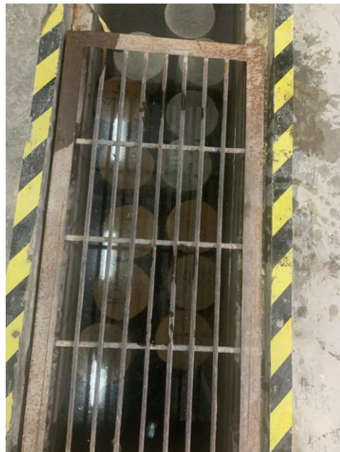
Gambar L-1. 14 Proses Perendaman Beton Geopolimer
