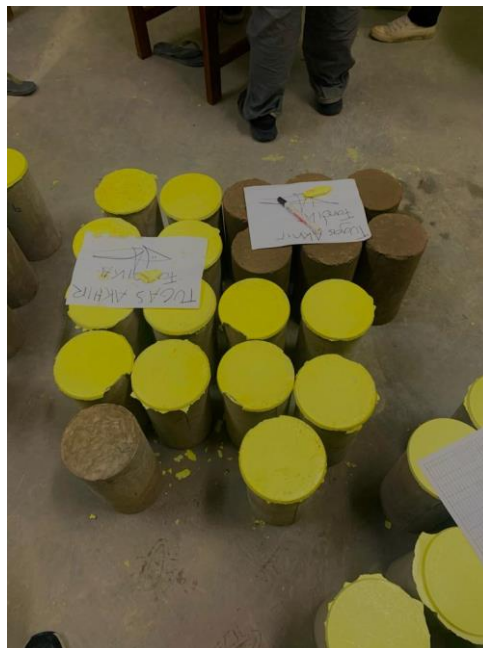
Gambar L-1. 16 Beton Geopolimer Setelah di Caping
