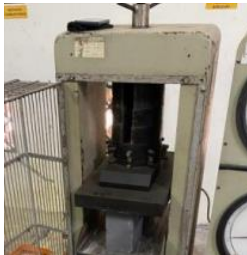
Gambar 5.8 Pengujian Kuat Tekan
