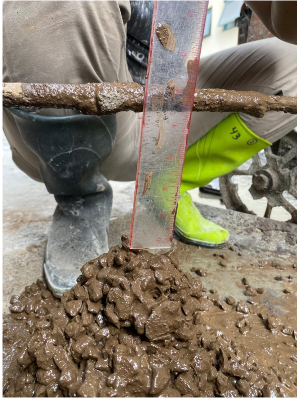
Gambar L-1. 11 Proses Pengujian Slump
