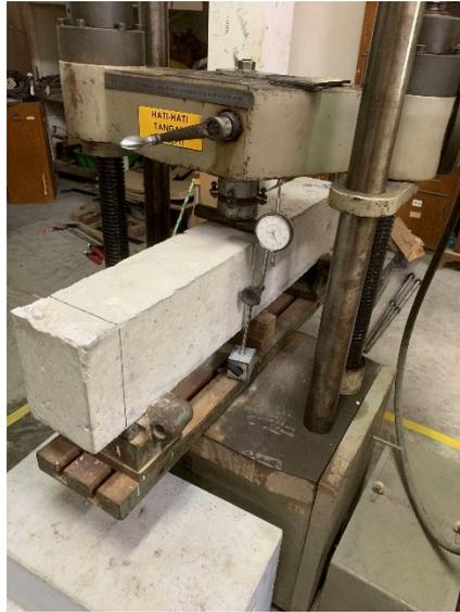
**Gambar 5.10 Mekanisme Pembebanan Benda Uji Balok**
