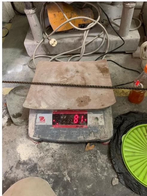
**Gambar L-5.2 Pengukuran Berat Tulangan Basalt Korosi**
