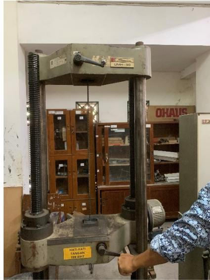
**Gambar 5.4 Pengujian Tarik Tulangan Basalt**
