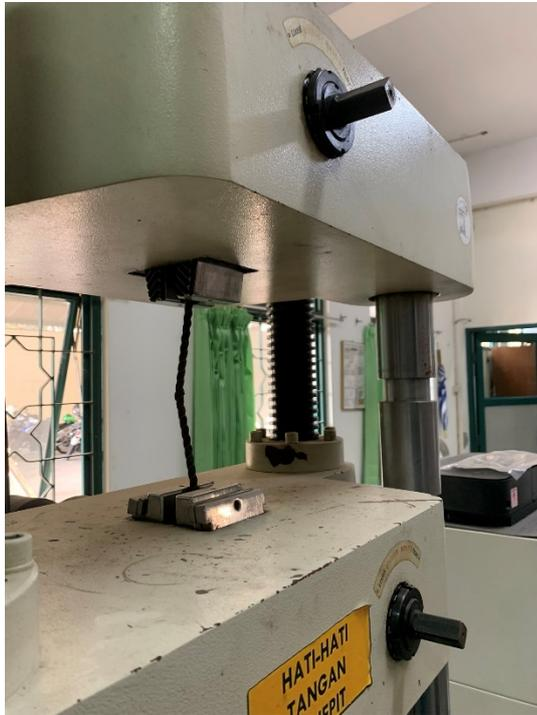
**Gambar L-6.1 Pengujian Tarik Tulangan Basalt**
