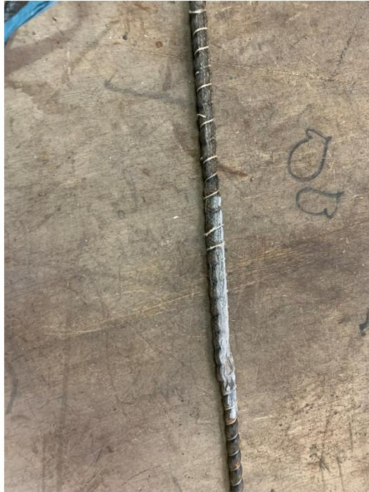
**Gambar 5.6 Bekas Cengkraman Pada Tulangan Basalt Akibat Los Dari Mesin**
