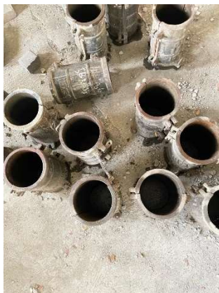
Gambar L-9. 15 Cetakan Benda Uji Silinder
