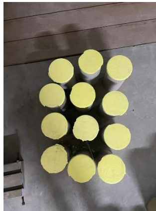
Gambar L-10. 5 Penyiapan Benda Uji serta Capping Sebelum Pengujian
