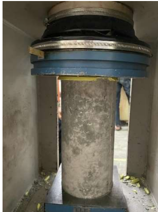
Gambar L-10. 7 Pengujian Kuat Tekan Silinder Beton
