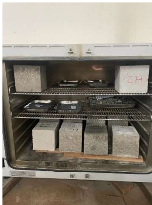
Gambar L-10. 9 Pengujian Absorpsi Beton
