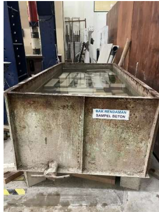
Gambar L-10. 4 Bak Perendaman Beton
