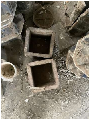
Gambar L-9. 13 Cetakan Benda Uji Kubus
