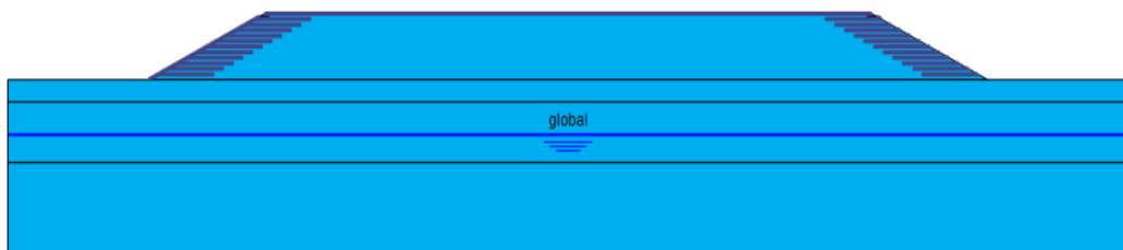
Gambar L-16.3 Flow Conditions pada Lereng Timbunan 6 m Masa Konstruksi Geotekstil Berlapis
