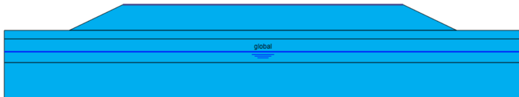
Gambar L-11.3 Flow Conditions pada Lereng Timbunan 6 m Masa Konstruksi Dengan Perkuatan Matras Bambu
