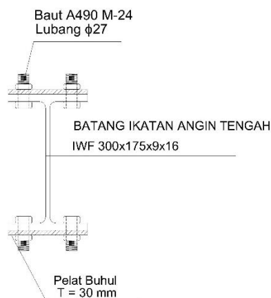
Gambar 5.66 Tampak Melintang Sambungan Baut Ikatan Angin Tengah
