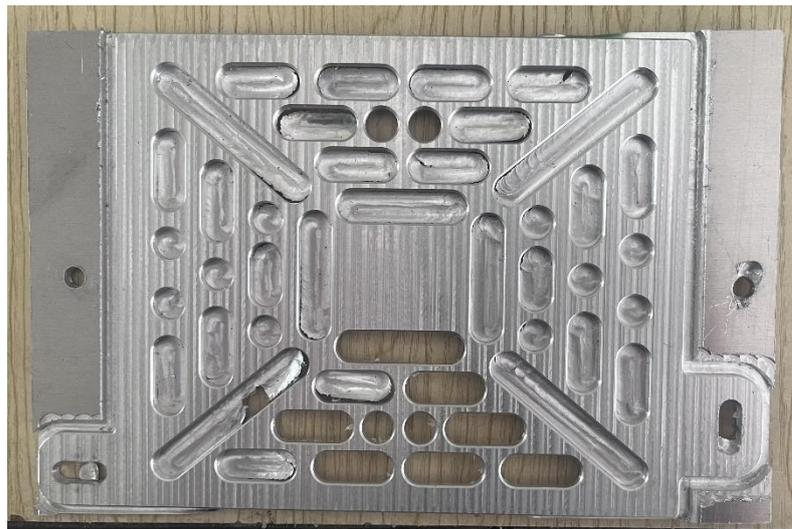
Gambar 4.38 Bagian sisa-sisa aluminium produk tidak terlepas secara sempurna
