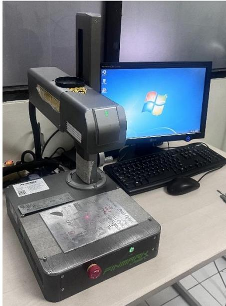
Gambar 3.4 Mesin *Laser Marking*
