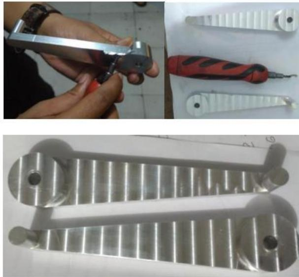
Gambar 2.1 Hasil Pembuatan *End grip* Sepeda Motor
