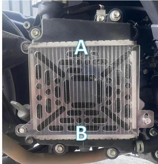
Gambar 4.16 Pemasangan Prototipe Produk ke Motor Yamaha Aerox 155 VVA
