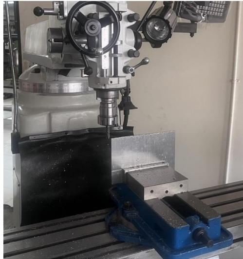
Gambar 4.19 Proses *Facing* menggunakan Mesin Frais
