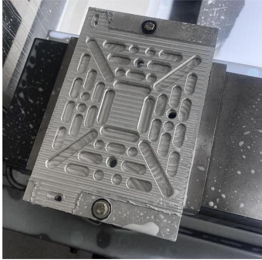
Gambar 4.33 Hasil Pemesinan *2D Chamfer 1* Produk
