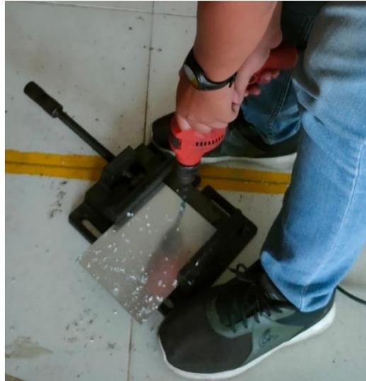
Gambar 4- 35 Pembuatan lubang untuk pemasangan pada *jig*
