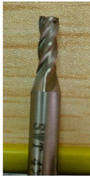
Gambar 3- 8 *End mill* 4 mm
