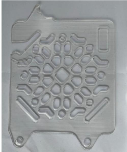
Gambar 4- 27 Hasil pemesinan *prototype* produk menggunakan *jig* baru
