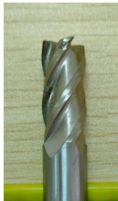
Gambar 3- 6 *End mill* 10 mm
