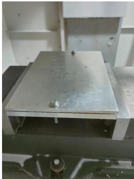
Gambar 4- 36 Pemasangan benda kerja ke *jig*
