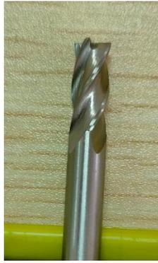
Gambar 3- 7 *End mill* 6 mm
