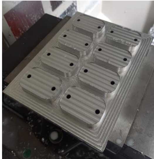
Gambar 4-56 Pemesinan jig yang sudah diubah panjangnya
