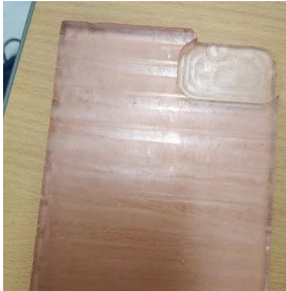
Gambar 4-30 Kegagalan pemesinan prototipe resin produk bagian bawah
