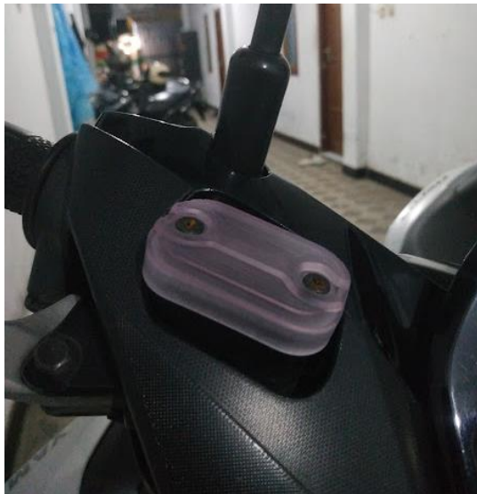
Gambar 4-36 Pemasangan prototipe resin produk pada tutup master rem Yamaha Aerox 155
