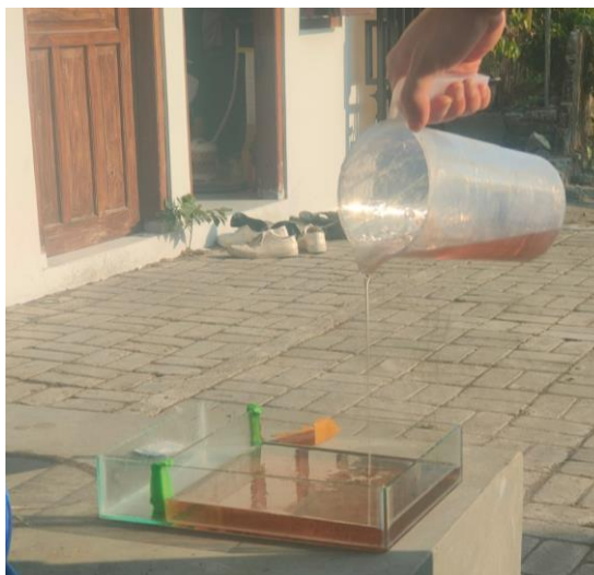
Gambar 4-23 Proses pencetakan resin
